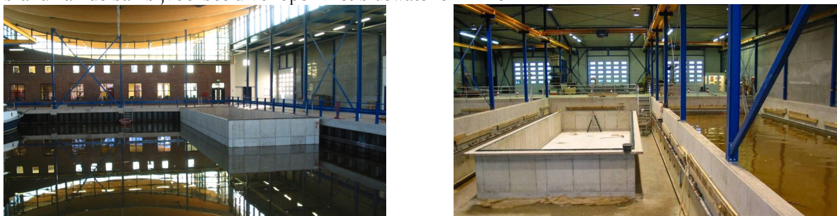
Afb. 2.6. Fabriekshal ABC Arkenbouw, plaats waar caissons worden gebouwd. Open Caissons worden veel toegepast voor woonarken.
